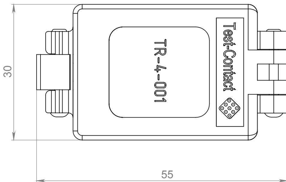
Рис. 1. Габаритные размеры КУ
