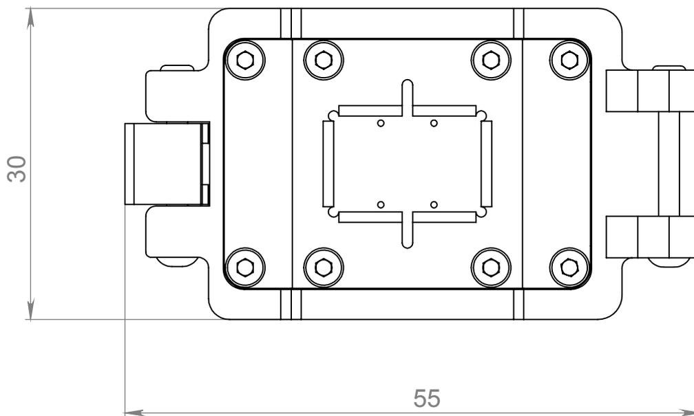
Рис. 1. Габаритные размеры КУ (вид сверху без крышки)
